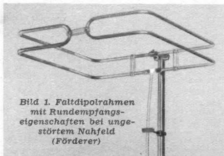
Bild 1. Faltdipolrahmen mit Rundempfangseigenschaften bei ungestörtem Nahfeld (Förderer)
